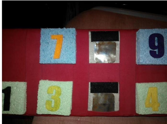
Panel frontal: teclas con esponjas de 6x6x2 cm. Detalle del velcro para sujetar la esponja. Recubrir la madera con goma eva. La parte metálica no tiene porque ser tan grande con una chincheta sería suficiente para detectar el contacto.
