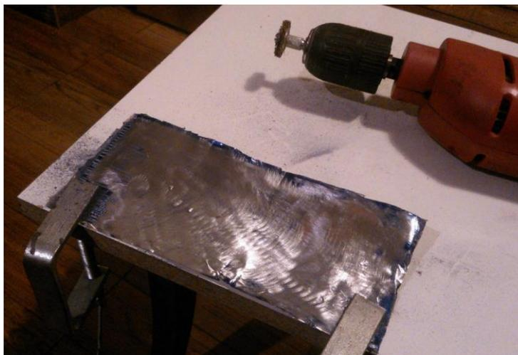
Lata de refresco cortada y lijada por ambos lados, para sacar los contactos de las teclas. Luego se marcan con un rotulador y se cortan con unas tijeras.
