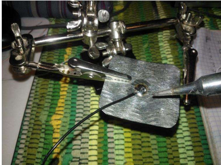
En cada chapa se suelda un cable, que luego irá a la regleta de conexiones donde se conecta Makey Makey.
